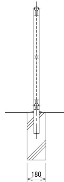
胴縁に金網取付断面図 S=1:3
