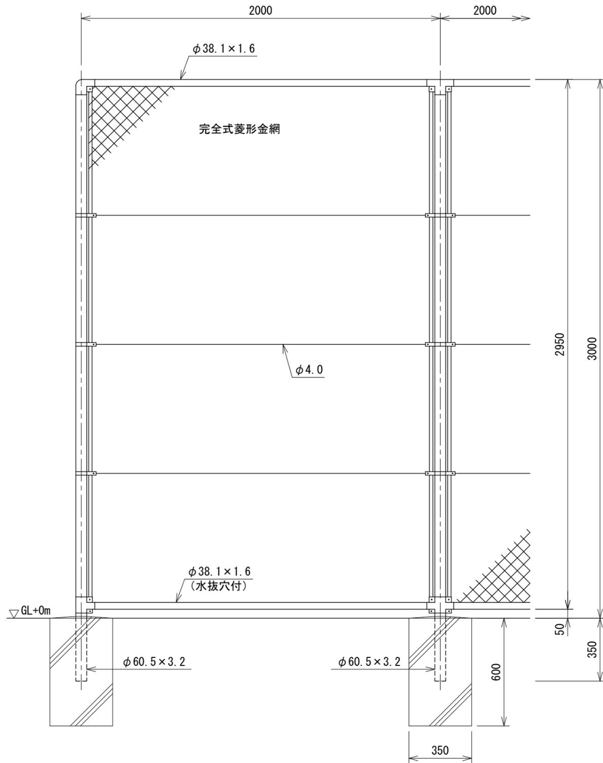
胴縁に金網取付断面図 S=1:3
