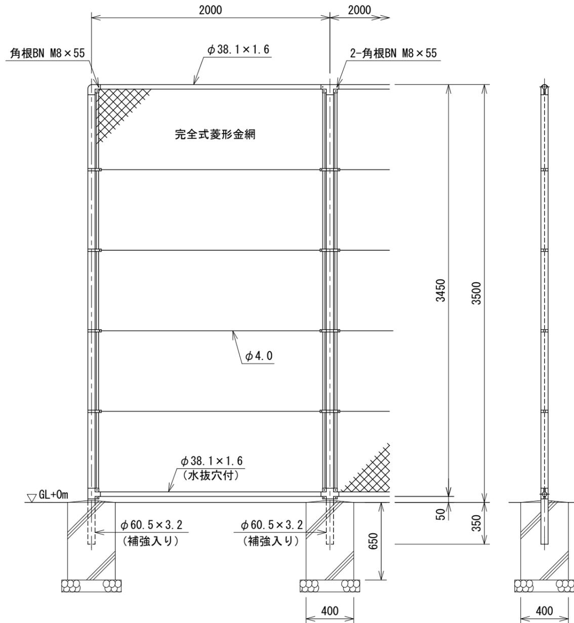
胴縁に金網取付断面図 S=1:3
