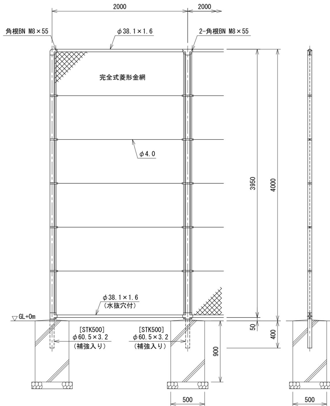
胴縁に金網取付断面図 S=1:3
