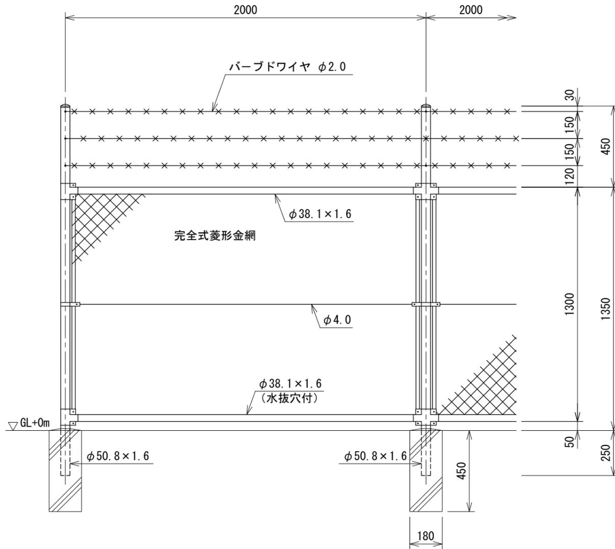
胴縁に金網取付断面図 S=1:3
