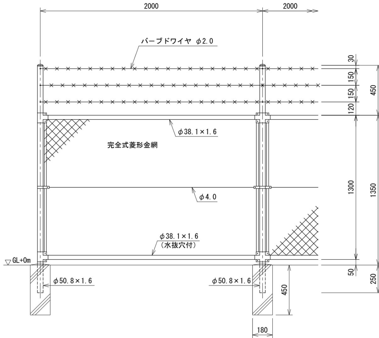
胴縁に金網取付断面図 S=1:3
