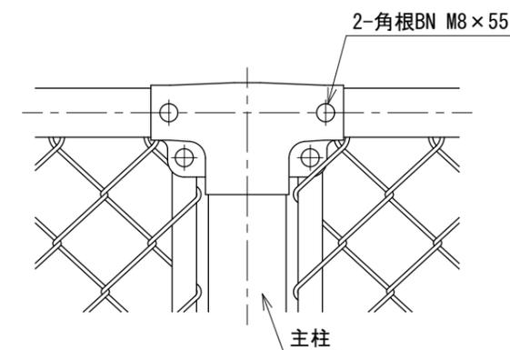
胴縁に金網取付断面図 S=1:3
