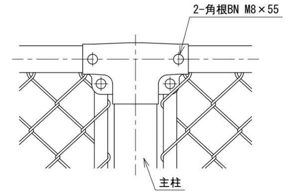
胴縁に金網取付断面図 S=1:3
