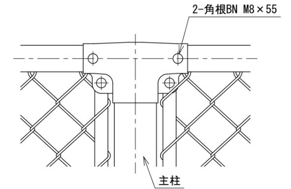
胴縁に金網取付断面図 S=1:3
