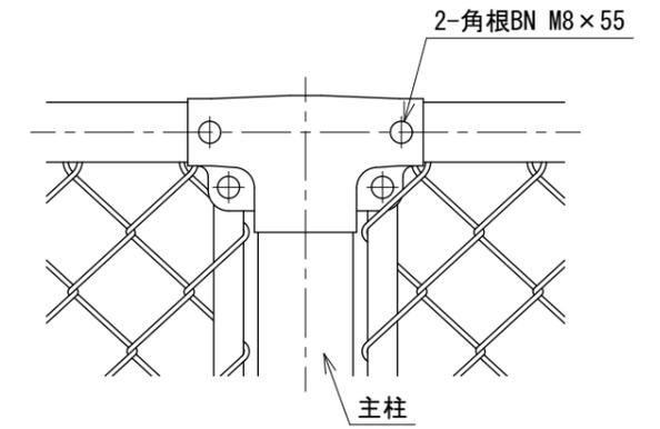
胴縁に金網取付断面図 S=1:3
