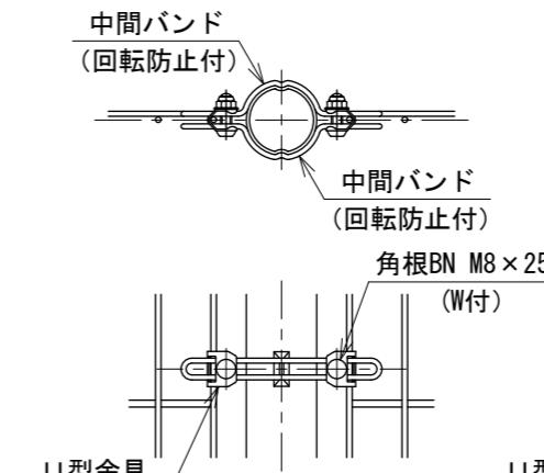
標準的な取付図 パネルと柱のすきまがせまい場合の取付図
