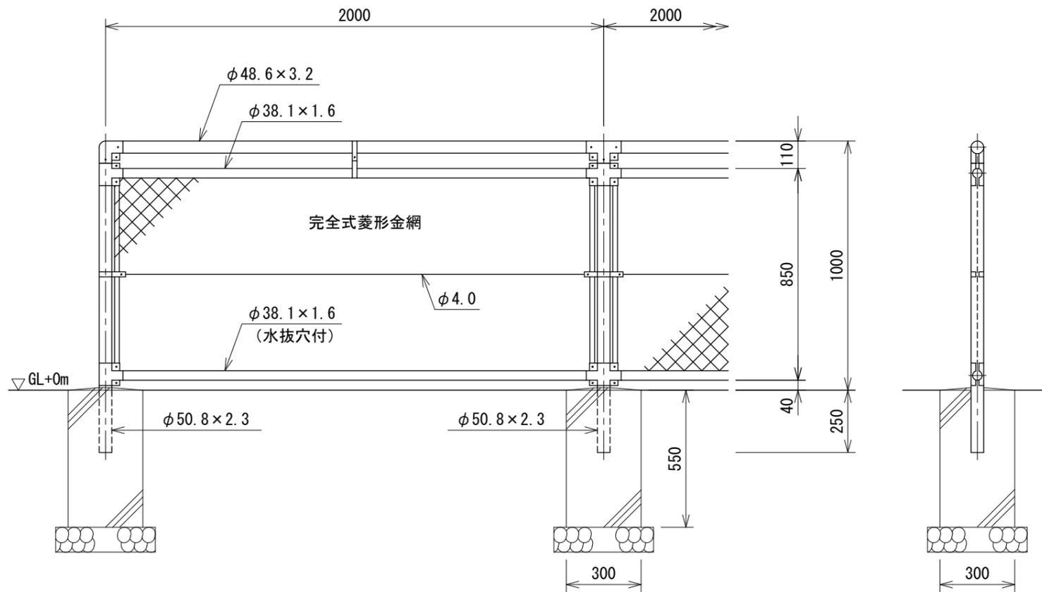
胴縁に金網取付断面図 S=1:3
