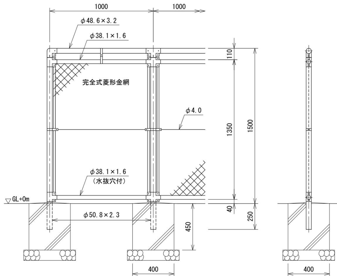
胴縁に金網取付断面図 S=1:3
