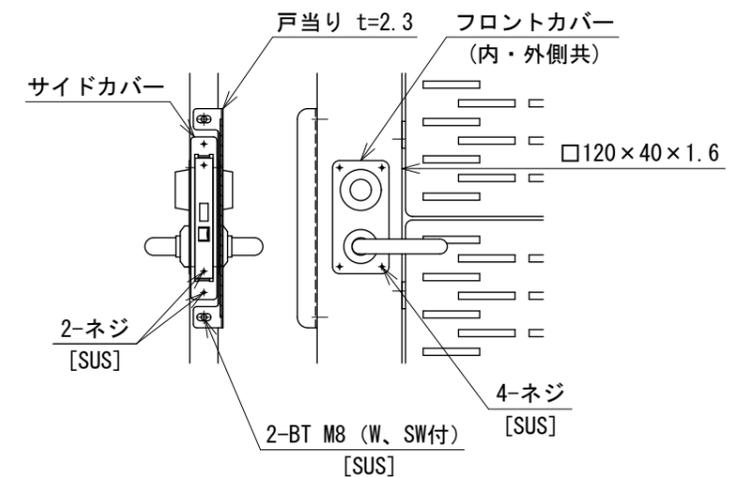
2. シリンダー錠、レバーハンドル、ストライク、戸当り、落とし、蝶番 (門柱側)、フロントカバー、サイドカバー、隙間防止プレートは本門扉に現地にて取付けとする。
