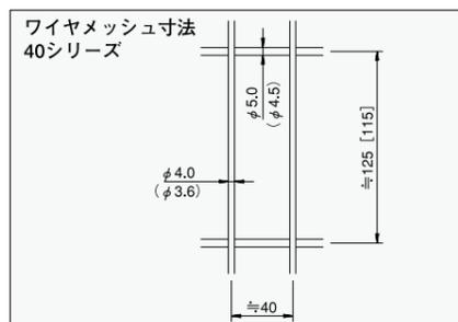
※ ( ) は芯径寸法、 [ ] はUN770・870・1770・1970の上段寸法を示します。
